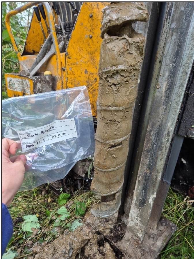
Kuva 2. Näyte "P006 0,5-1", jossa todettiin potentiaalisesti hapanta sulfaattimaata kokonaisrikkipitoisuuden perusteella, mutta näytteessä ei todettu merkittävää hapontuottopotentiaalia.
