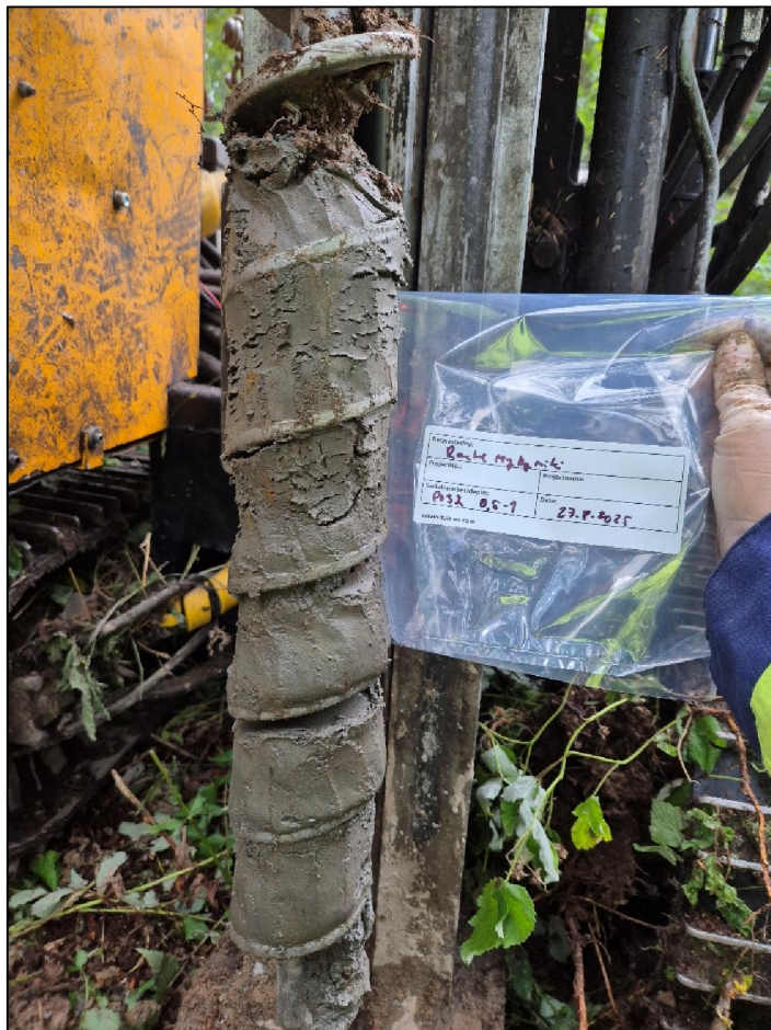
Kuva 4. Piste P032 näyte syvyydeltä 0,5-1 m. Näytteessä todettiin potentiaalisesti hapanta sulfaattimaata kokonaisrikki- ja hapontuottopotentiaalin perusteella.
