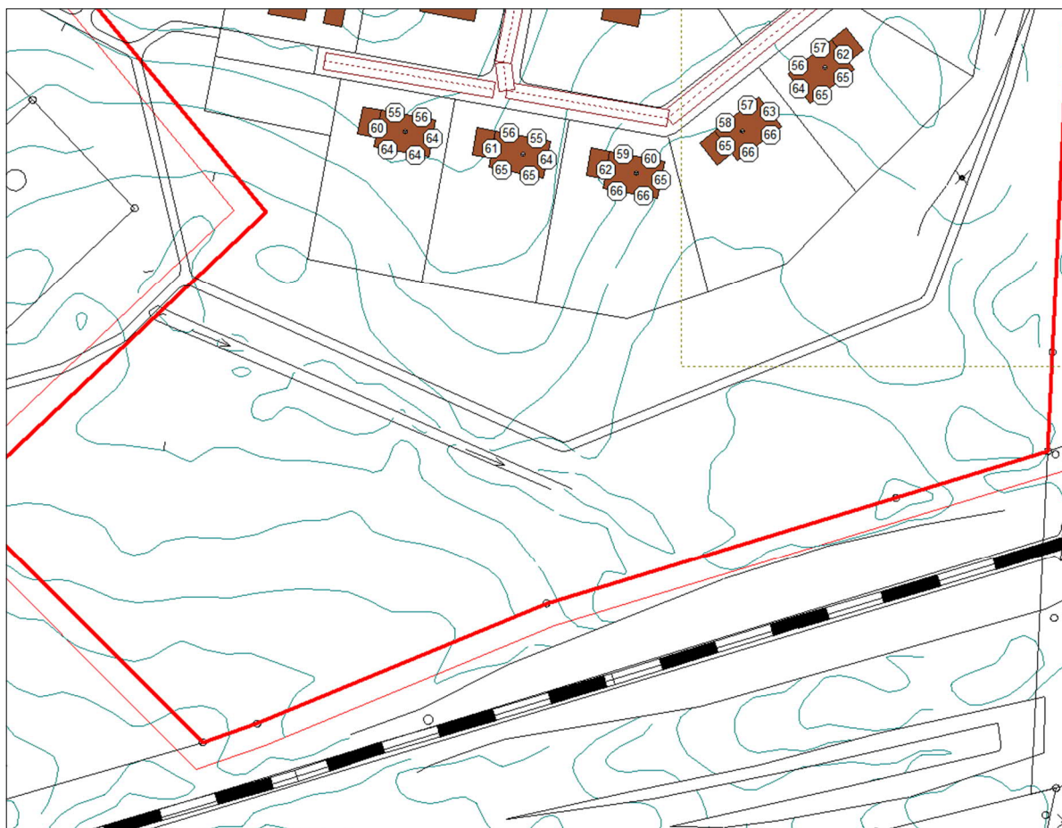
Kuva 2. Rataa lähimpänä sijaitsevien rakennusten julkisivuihin kohdistuvat enimmäisäänitasot L_{Amax} ovat enintään 66 dB. Etäisyys radan ja lähimmän asuinrakennuksen välillä on noin 90 m.
