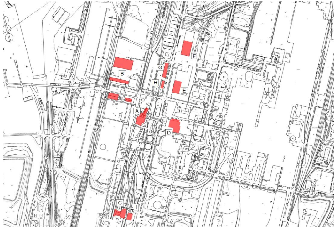
Kuva 21. Ensimmäisen vaiheen rakennukset nykytilanteen kartassa: A masuuni, B sintraamokokonaisuus, C harkkovalimo, D voimalaitos, E korjaamo, F keskusvarasto, G tp-huoltorakennus, H masuunikonttori, I senkkakorjaamo.
