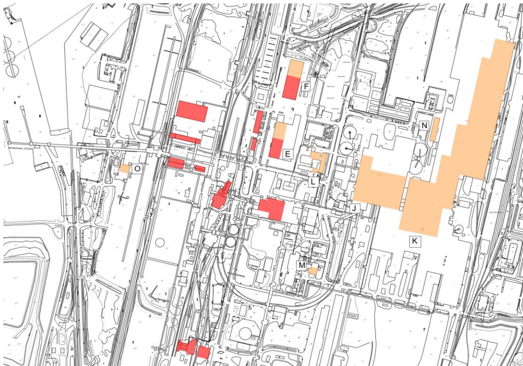
Kuva 24. Toisen vaiheen uudet rakennukset ja vanhojen laajennukset nykytilanteen kartalla: E korjaamon ensimmäinen laajennus, F keskusvaraston laajennus, J terässulatto, K valssaamo, L tutkimuskeskus, M ilma-kaasu- eli happitehdas, N valssaamon huoltorakennus, O kalkinpolttamo.
