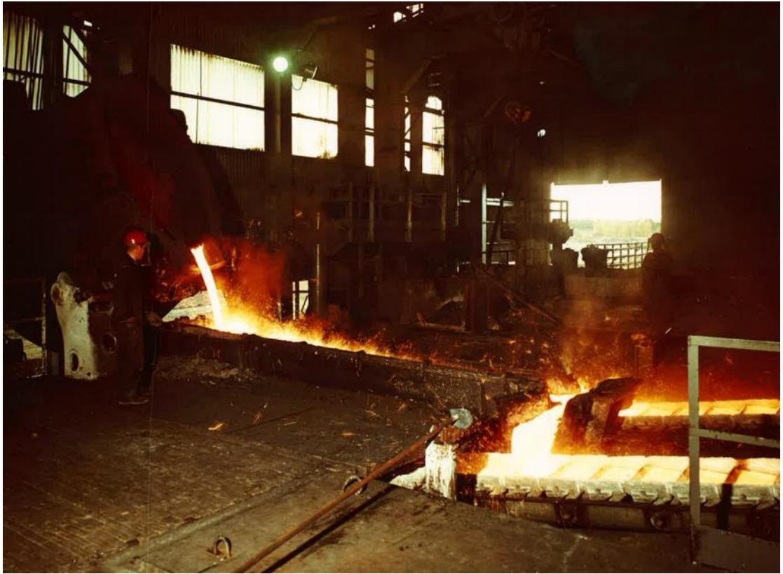
Kuva 48. Harkkovalimoa sisältä 1970-luvulla. Sulaa rautaa kaadetaan senkasta muotteihin, jotka liikkuvat hihnalla. SSAB:n arkisto.
