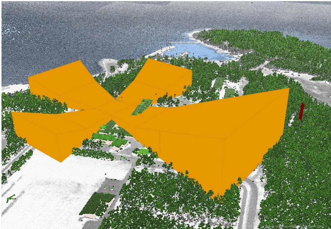
Kuva 21: Helikopteriliikenteen kattokenttävaihtoehto sairaalan katolla ja siihen liittyvät lähestymis- ja laskeutumissektorit EC135 helikopterityypillä. Helikopterin laskupaikka on sijoitettu uuden III-kerroksisen sairaalarakennuksen katolle, +19 metrin korkeuteen merenpinnasta. Korkeus on arvioitu maanpinnan keskikorkeuden ja rakennuksen sekä helikopterikentän rakenteiden korkeuden perusteella. Maanpinnan keskikorkona on käytetty +7 metriä, rakennuksen korkeudeksi on arvioitu 11 metriä (III kerrosta sekä sokkeli ja kattorakenteet) ja laskupaikan rakenteiden korkeudeksi 1 metri. Tarkastelun perusteella ainoa sairaalan katolle sijoitetun helikopterin laskupaikan estepinnoille osuva este on viereinen V-kerroksinen sairaalarakennus, joka kuitenkin puretaan, mikäli uusi sairaalarakennus rakennetaan III-kerroksisena. Purettava rakennus näkyy kuvassa vihreänä suorakaiteen muotoisena kappaleena sektoreiden lähtöpisteen oikealla puolella. Läheinen 43 metriin merenpinnasta kohoava lämpölaitoksen piippu, joka näkyy kuvan oikeassa laidassa tumman punaisena, ei osu EC135 helikopterin suorituskyvyn mukaan määritellyille estepinnoille. (© Helikopterikenttä, toteutettavuus- ja tilavarausselvitys / Ramboll Finland Oy, 2022).
