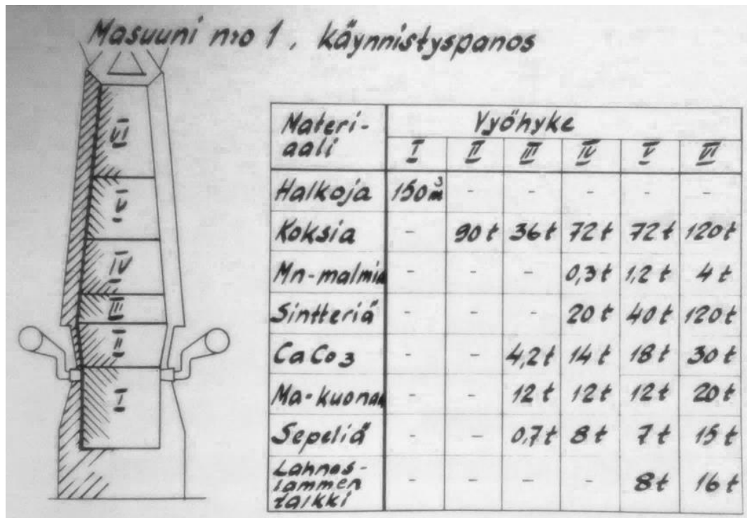
Kuva 27. Ensimmäisen masuunin käynnistyksessä masuuniin ladattujen materiaalin lista ja suhteet. Kuva Titaani-lehti 5/1976.
