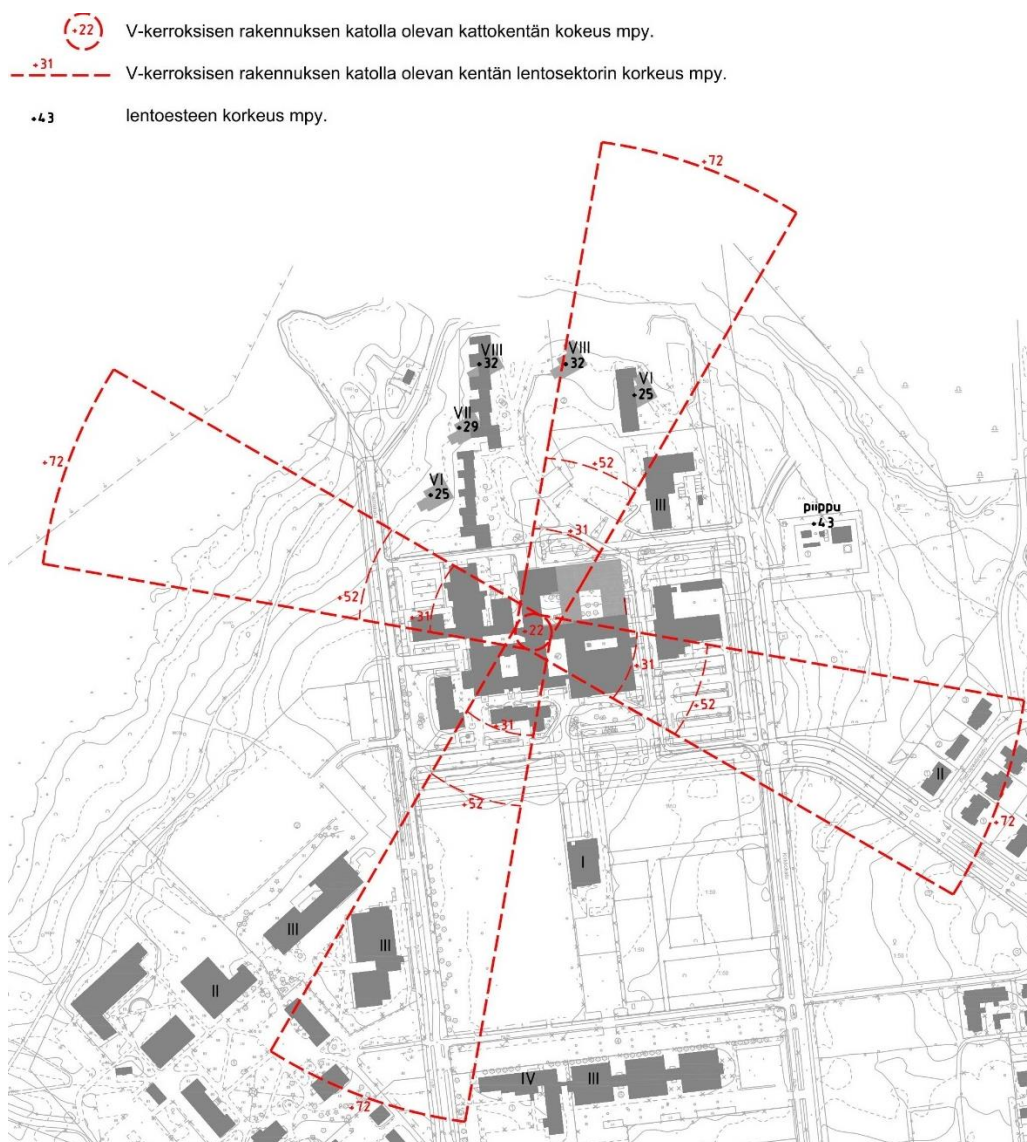
Kuva 25. Alustava esimerkki helikopterin laskupaikan lentosektoreista ja vaadittavasta estevapaasta korkeudesta, kun kenttä sijoitetaan V-kerroksisen rakennuksen katolle. Helikopterikenttä edellyttää kahta vastakkaista lentosektoria, joiden tulee olla vapaita lentoesteistä. Korkeusrajoitteet ja sektoreiden leveydet tarkentuvat erilliselvityksen myötä).
