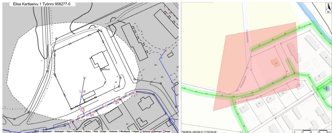
Kuva 6. Tietoliikenne- ja sähköverkot.
